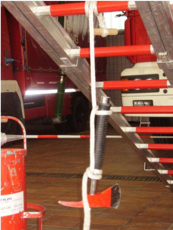
Befestigung an der Leiter mit einem Mastwurf
