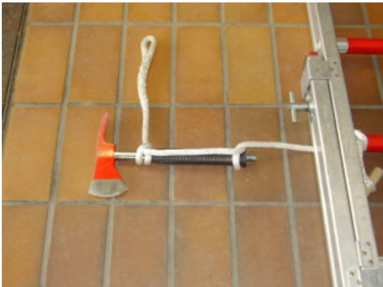
Befestigung des Beils mittels Mastwurf und Halbschlag
